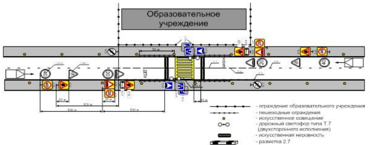
Рис.3 Пример нанесения дорожной разметки
